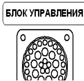
Рисунок 3. Разъем подключения жгута блока управления
